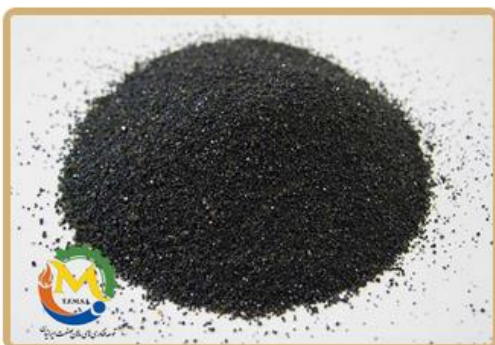
ماسه مجرای پاتیل (Compound) Nozzle Filling
